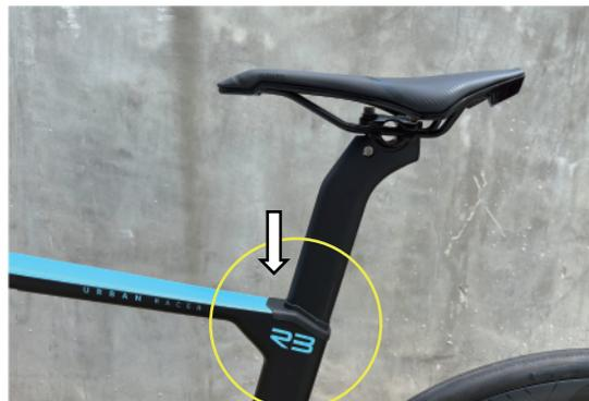
6. 調整座管高度：請將座管束往上，再使用六角扳手鬆開座管，調整到適合高度後再鎖緊。
