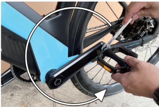
如需將車輛裝回原箱中，請依前述步驟倒退回復即可裝回。裝回時，固定卡扣依下圖說明更好裝回：
